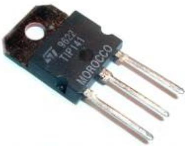
El tip 141 es un transistor de potencia, tienen multiples usos, pero en este caso lo que hace es regular la intensidad o corriente con la que alimentas los led. Tienen 3 patillas, una se llama Base, otra es el colector y la tercera es el emisor.
