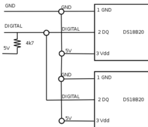
Para este código estamos usando tres sensores de temperatura. Uno de ello, nos tiene que dar el valor del agua del acuario, y en función del valor captado lo compara con el valor deseado y activa o desactiva el rele del calentador.(Es importante, poner el regulador de la temperatura del calentador un poco por encima de la deseada, de esta manera, si el Arduino activa el enchufe, el calentador debe funcionar correctamente).
