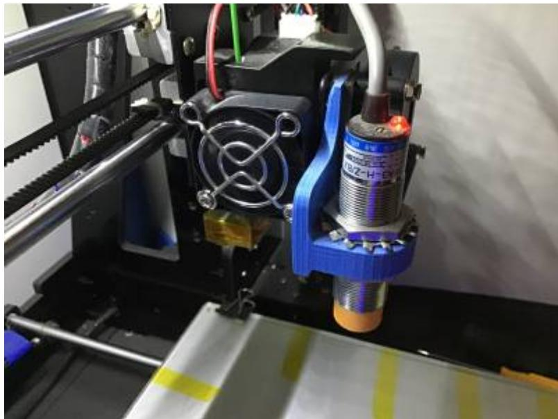
El soporte que he instalado para montar el sensor es [ESTE](#)
