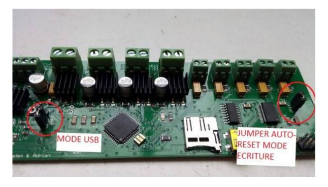
Descarga y descomprimes el archivo ZIP. En él debes ejecutar el archivo **Arduino.exe** luego debes elegir la tarjeta **"SANGULINO W/ATmega1284p 16mhz"** y seleccionar el puerto de comunicación, por defecto suele ser el 3 pero da igual, eso no afecta.
